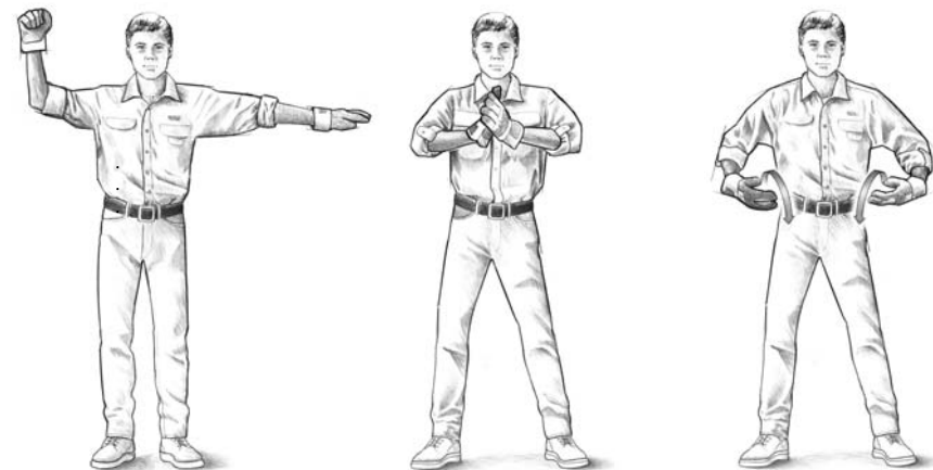
5) Arrêt du treuillage Pour signaler l'arrêt du treuillage, fermez le poing, paume en direction du conducteur, suffisamment haut pour que le conducteur puisse le voir, et tendez l'autre bras à hauteur de l'épaule.
